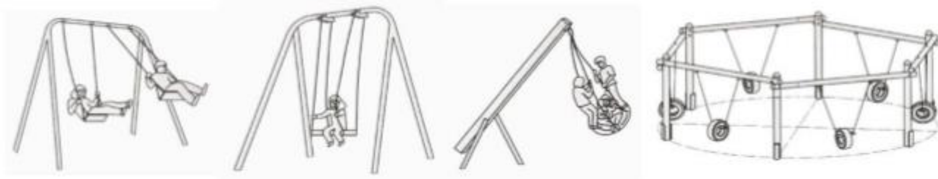
Obrázek č. 1 Příklady typů závěsných houpaček: s jednou rotační osou, s několika rotačními osami, s jedním bodem zavěšení, skupinová houpačka (ČSN EN 1176-2)
